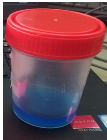
Сурет 28 – (a) ұнтақ күйдегі және (b) 10^{-6} М концентрациядағы деионизацияланған суда ерітілген сұйық күйдегі МВ
